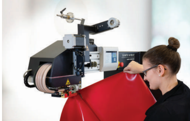
Инновационная технология горячего клина
