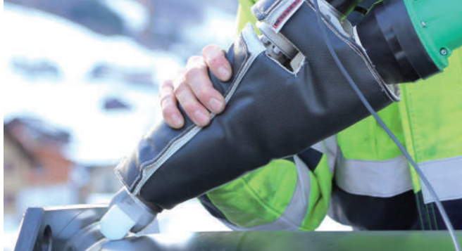
Защитный кожух предотвращает потерю тепла и защищает оператора от контакта с горячим корпусом
