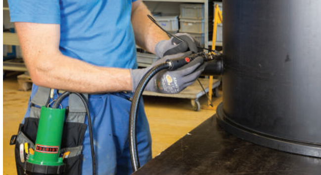
Аппарат LABOR S с MINOR в качестве внешнего источника подачи воздуха
