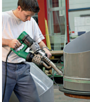
Экструдер FUSION 3C при сварке резервуара
