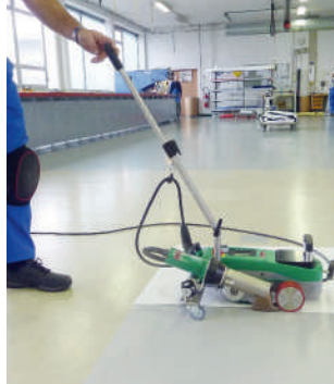
Стабильное качество сварки внахлёт
