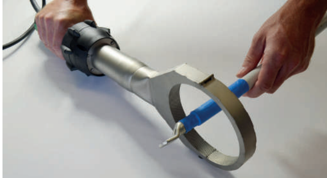
Процесс термоусадки при помощи аппарата ELECTRON ST
