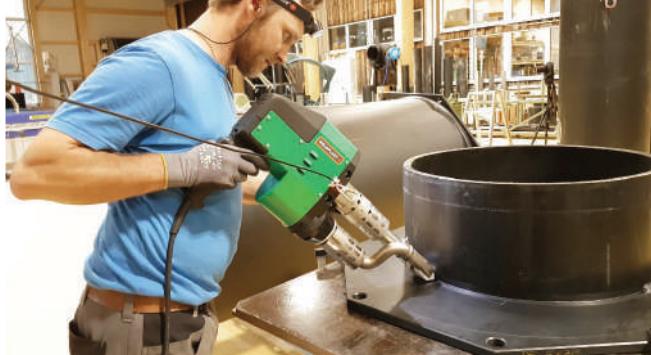
Мощный экструдер WELDPLAST S4 в работе
