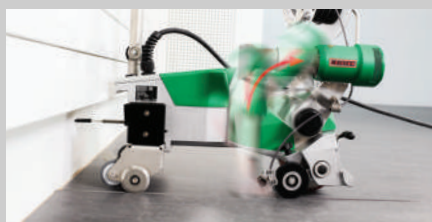
Автоматический механизм подъёма сварочного узла
