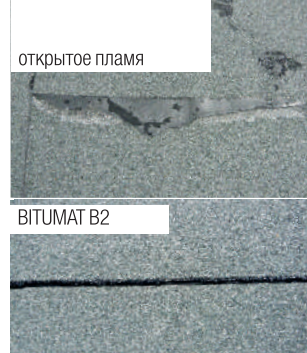
Открытое пламя BITUMAT B2 Однозначно лучший результат по сравнению со сваркой открытым пламенем
