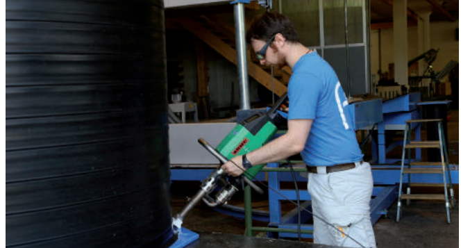
Эргономичная рукоятка экструдера WELDPLAST S6 существенно облегчает работу сварщика
