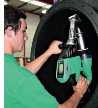
Удобный ручной сварочный экструдер WELDPLAST S2 в работе
