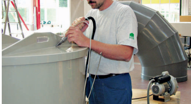
Вентилятор ROBUST подаёт воздух к WELDING PEN
