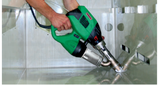
Компактный ручной сварочный экструдер WELDPLAST S2 — сварка в ограниченном пространстве
