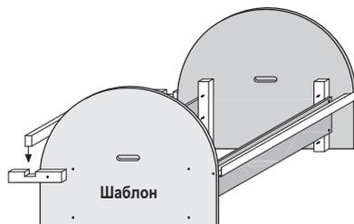
Для получения криволинейных поверхностей мокрым способом используют другие свойства КНАУФ-листа арочного – пластичность во влажном состоянии, когда КНАУФ-листу придается необходимая изогнутая форма заданного радиуса. Впоследствии, после полного высыхания, в зафиксированном в этой форме состоянии, КНАУФ-лист сохраняет приданную форму и механические характеристики.
