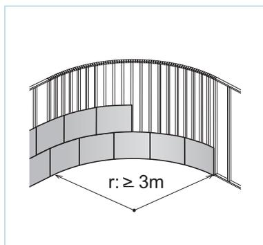
Перед закреплением плит рекомендуется предварительно согнуть плиту по необходимому радиусу. Возникающие при этом волосяные трещины не приводят к потере прочности и эксплуатационных свойств плит.
