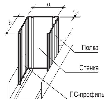
**Монтаж листов** необходимо производить в одном направлении со стороны стенки стоечных профилей. Благодаря этому ввинчиваемый винт не будет отгибать внутрь полку профиля при креплении следующего листа.
