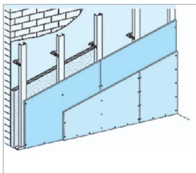
**С 623** Конструкция – одинарный металлический каркас из ПП- и ПН-профиля, прикрепленный к базовой стене при помощи прямых подвесов с шагом 1,5 м и обшитый одним или двумя слоями малоформатных КНАУФ-листов.
