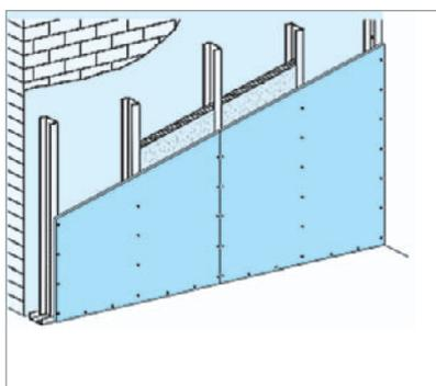
**С 625** Конструкция – металлический каркас из ПС- и ПН-профилей, обшитый одним слоем малоформатных КНАУФ-листов.
