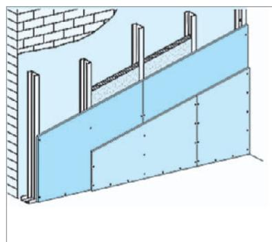
**С 626** Конструкция – металлический каркас из ПС- и ПН-профилей, обшитый двумя слоями малоформатных КНАУФ-листов.
