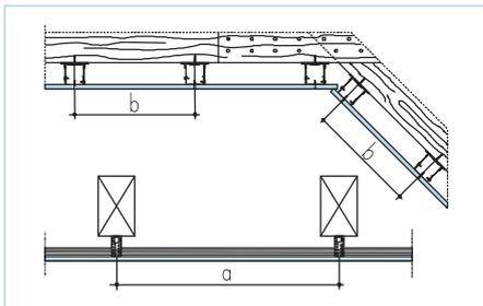
Основными элементами облицовок являются деревянный (М 681) или металлический (М 682) каркасы из антисептированных пиломатериалов хвойных пород с влажностью  $12 \pm 3\%$ , а также одно- или двухслойная обшивка из гипсоволокнистых листов. Элементы металлического каркаса – профили ПП 60x27 и ПН 28x27, изготовленные из оцинкованной стали по ТУ 24.33.11 012 04001508 2020.
