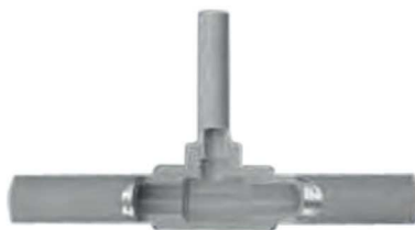
Рис. 44 Сварное соединение в разрезе
