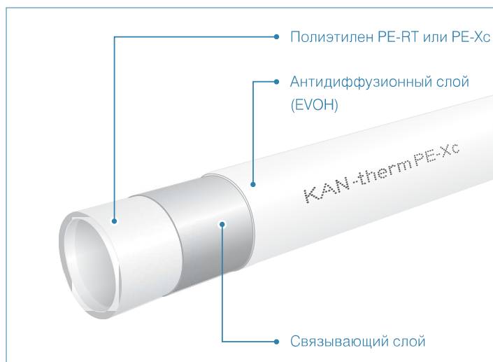
Рис. 1 Конструкция трубы PE-RT (PE-Xc) с антидиффузионным покрытием
