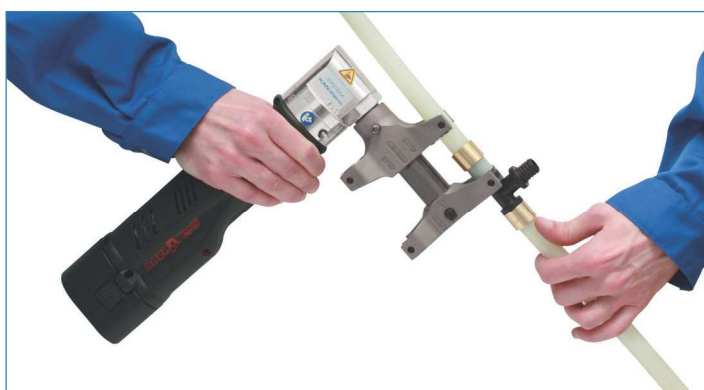
...аккумуляторного пресса. Фитинги должны фиксироваться только за фланец. Нельзя натягивать одновременно два кольца. Перед процессом натягивания необходимо оснастить щеки пресса соответствующими вкладышами.
