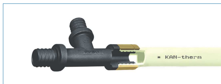
Рис. 8 Соединение Push в разрезе
