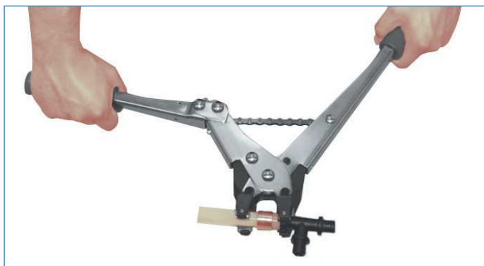
5. Натянуть кольцо на трубу при помощи инструмента для за-прессовки - ручного пресса...
