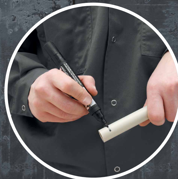
03 Обозначение глубины сварки.
