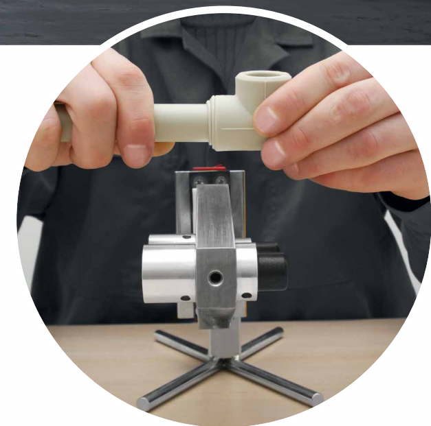
06 Фиксация и охлаждение соединения.
