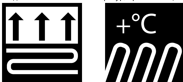
Рис. 21. Примеры маркировки материалов, используемых в напольном отоплении
