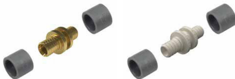
Рис. 49. Двухсторонний соединитель KAN-therm ultraLINE для труб PEXC, PERT 2 и PERTAL 2 с диаметрами 14 × 2; 16 × 2,2; 20 × 2,8; 25 × 2,5 мм.
