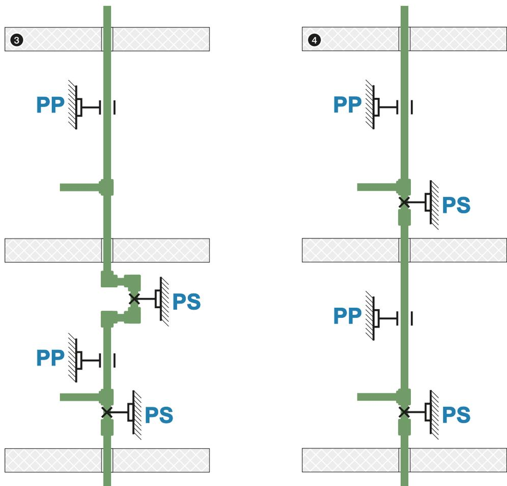
Максимальное расстояние между опорами для однородных труб Системы KAN-therm PP Green зависит от диаметра труб и температуры воды. Для вертикальных участков трубопровода расстояние между опорами можно увеличить на 30 %.
