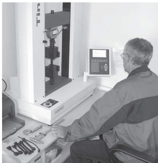
Рис. 5.6. Испытания стыковых сварных соединений в лаборатории ИКАПЛАСТ
