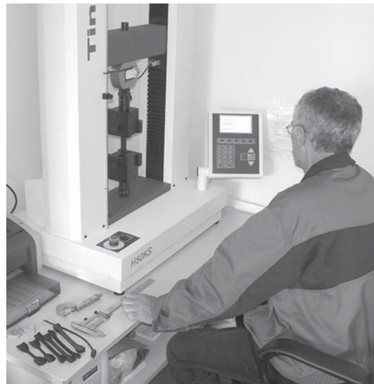
Фото 4.2.8. Испытания стыковых сварных соединений в лаборатории ИКАПЛАСТ
