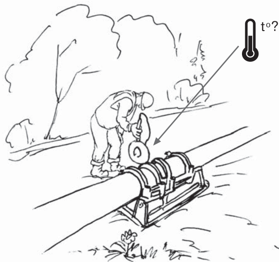
Рис. 4.2.9. Контроль температуры на поверхности нагревателя
