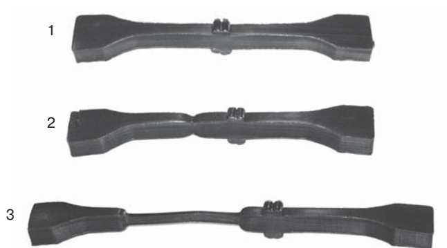
Фото 4.2.9. Образец с фрагментом стыкового сварного соединения (1).
