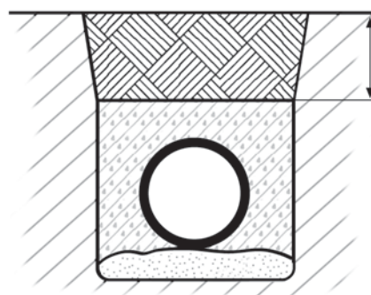
Рис. 4.1.5. Окончательная засыпка траншеи
