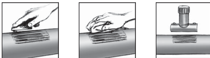
Рис. 4.2.15. Снятие оксидного слоя для установки седлового отвода
