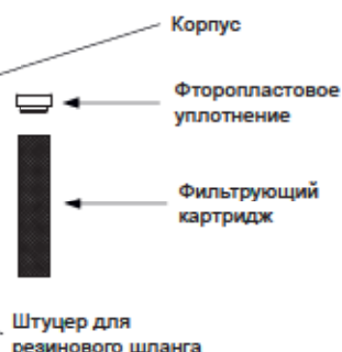
Схема обслуживания фильтра RBM
