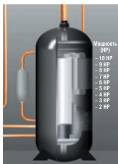
Компрессор с инверторным управлением. Мощность изменяется плавно
