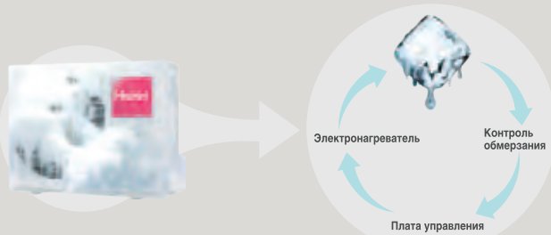
Нагреватель картера компрессора предотвращает холодный пуск.
