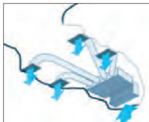
Установка в запотолочном пространстве
