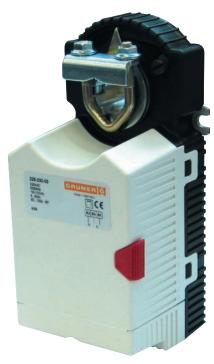
Стандартная версия с универсальным креплением скобой и антиторсионной дугой. Все приводы имеют кнопку ручного управления, механический ограничитель угла поворота и переключатель установки направления вращения (cw/ccw).
