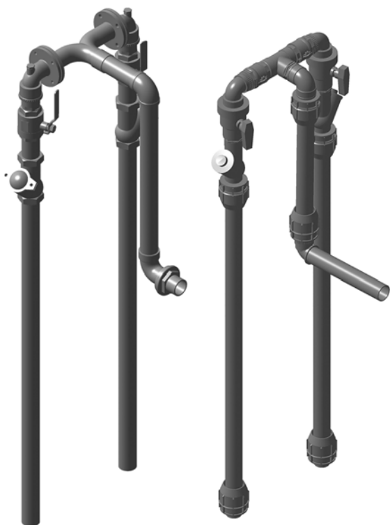
Рис. 10 GC, обвязки с S-образным коленом, D63 из полиэтилена или DN 50 из нержавеющей стали и общим выпускным патрубком
