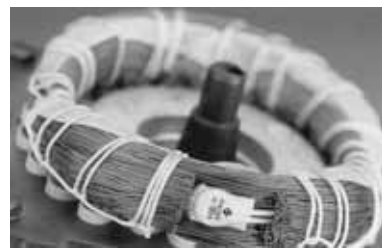
Рис. 28 Термовыключатель, встроенный в обмотку электродвигателя
