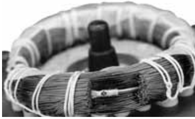
Рис. 26 Датчик РТС, встроенный в обмотку
