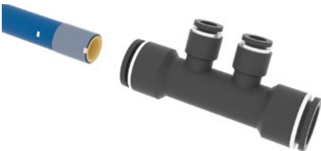
Фитинг надевается на трубу до упора. Труба 16 погружена на 27 мм, труба 8 - 20 мм. Можно ориентироваться по напечатанным на трубе обозначениям.
