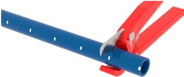
Труба обрезается ножницами перпендикулярно к оси трубы. Чтобы предотвратить сплющивание трубы следует трубу в ножницах повернуть.
