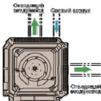
Как и КОМПАКТНЫЙ КАССЕТНЫЙ ТИП, полноразмерный КАССЕТНЫЙ ТИП допускает объединение с приточной вентиляцией и обеспечение подачи свежего воздуха до 15% от воздухопроизводительности внутреннего блока. Также существует возможность подать часть кондиционированного воздуха по отдельному воздуховоду в соседнее помещение.
