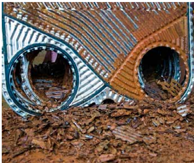
Пластинчатый теплообменник, забитый отложениями шлама
