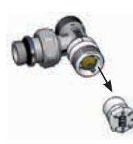
4. Убрать ключ регулировки и установить регулировочную пластиковую ручку или термостатическую головку.
