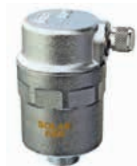
Рис. 1. При отсутствии воздуха в системе вода поднимает поплавок до полного закрытия затвора.
