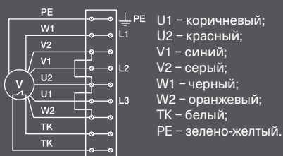
Схема 3 (Δ — 400 В, 3 ф.)
