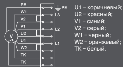
Схема 3 (Δ — 230 В, 3 ф.)
