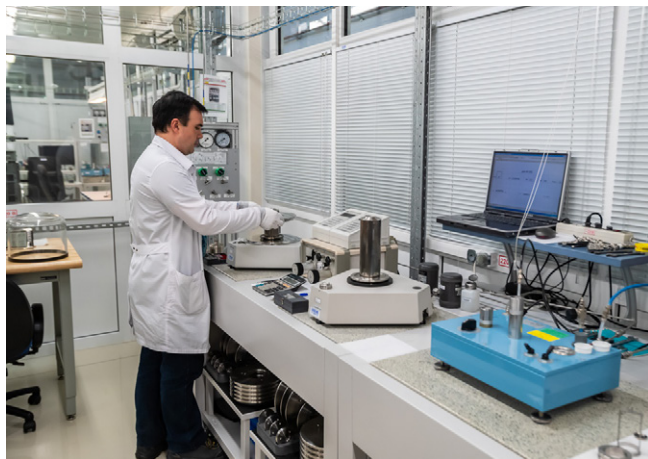
Работы по калибровке с использованием прецизионного грузопоршневого калибратора давления PG7601
