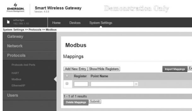
Рис.3. Экран соответствия регистров Modbus.
