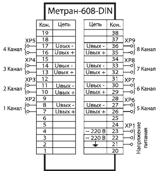
Рис.7. Схема подключения блоков Метран-608 (исполнение DIN).
