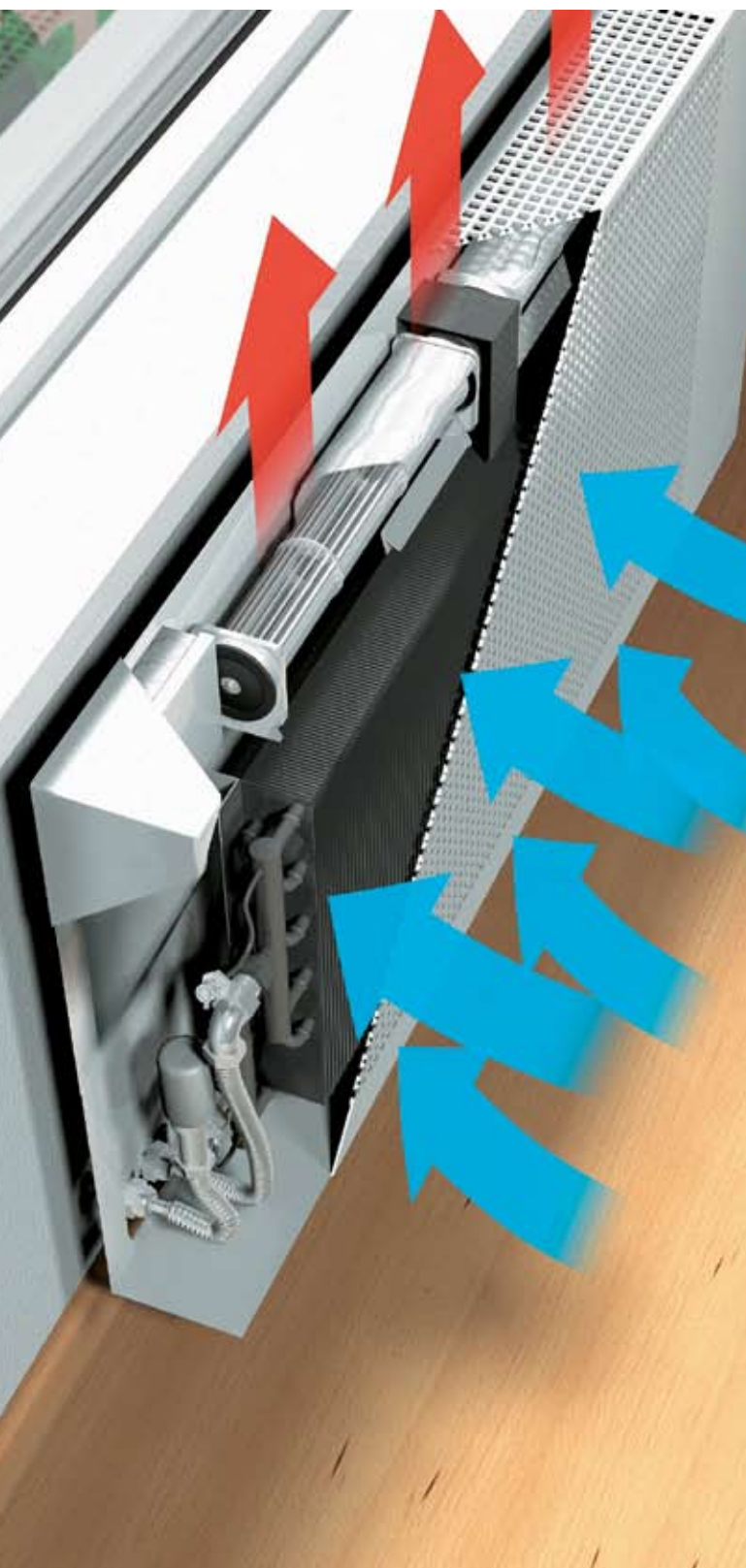
Отопление (естественная конвекция)
