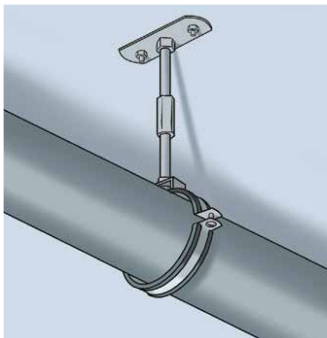
Крепеж трубопроводов к потолку
