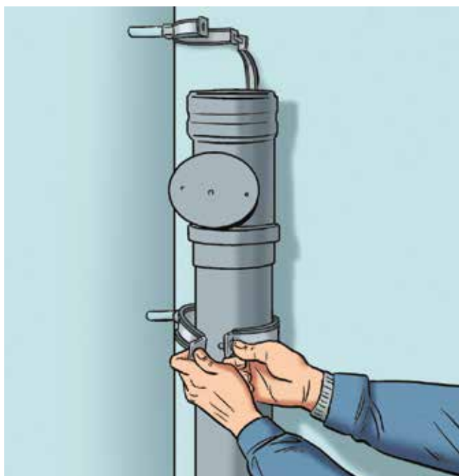
Крепеж трубопроводов к стене
