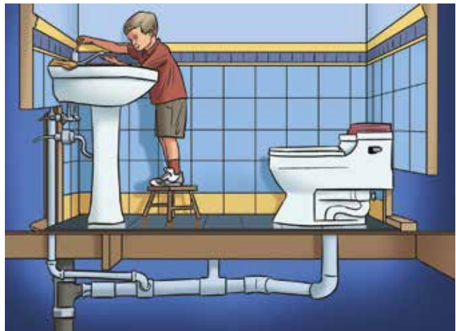
Закрытый способ прокладки
