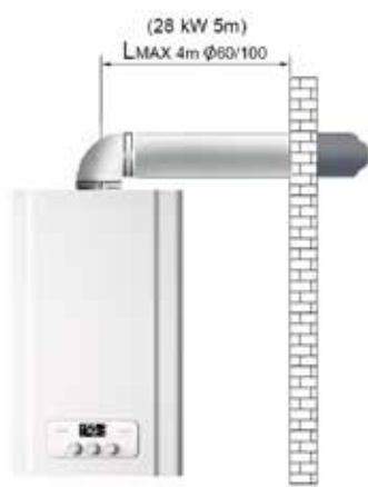
оризонтальная система дымоудаления (Lмакс. расстояние с одним коленом: 4 м, Ø60/100) (Lмакс. расстояние с одним коленом: 6 м, Ø80/125)
