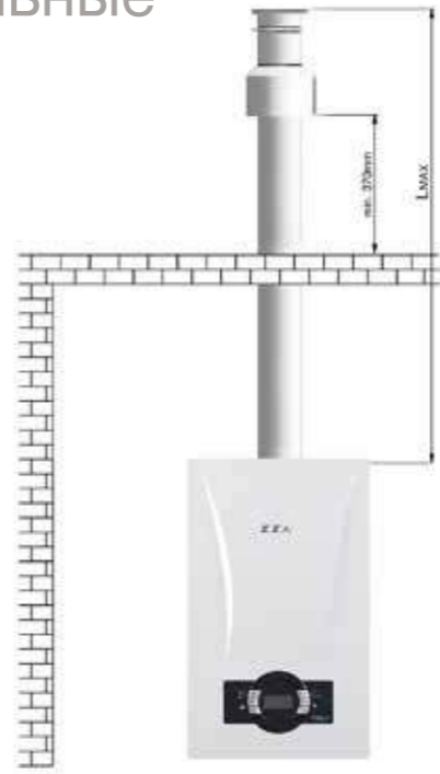
Вертикальный коаксиальный дымоход Максимальная высота L макс.: 10 м, 60/100 Максимальная высота L макс.: 20 м, 80/125
