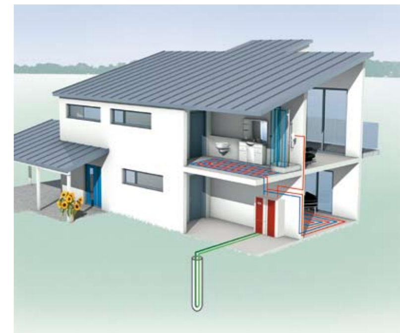
Тепловой насос типа "соляной раствор-вода" с грунтовыми зондами
