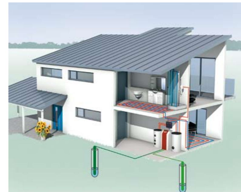
Тепловой насос типа "вода-вода" с водозабором грунтовых вод
