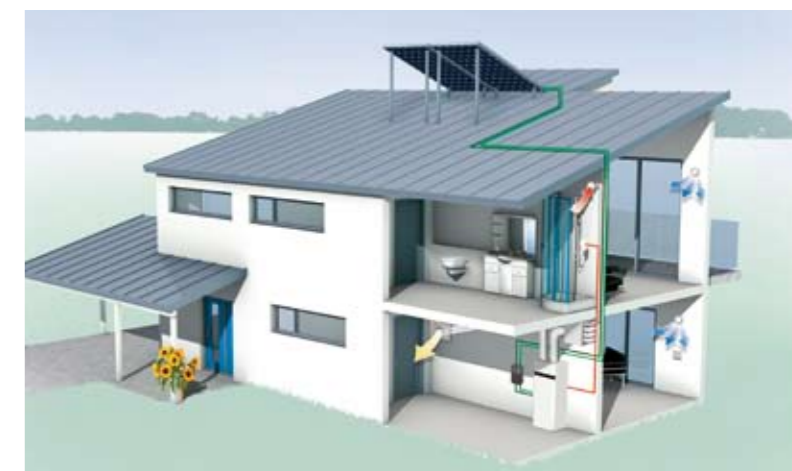
Солнечные коллекторы в сочетании с компактной вентиляционной установкой LWP 300W со встроенной системой приготовления горячей воды
