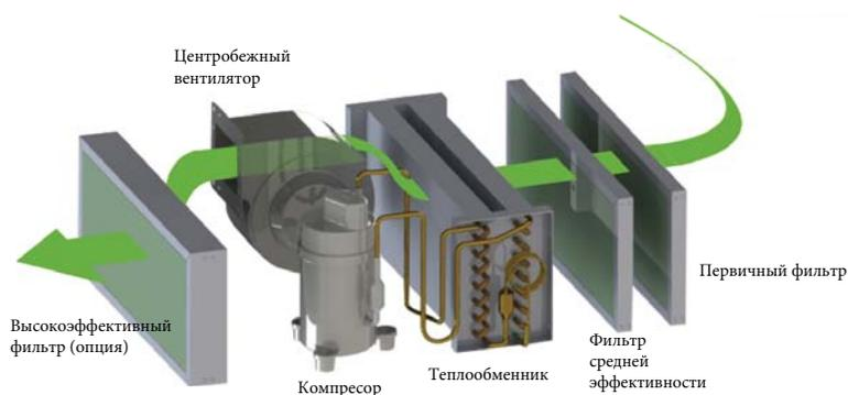
Эта серия систем осушения забирает воздух из помещения для прохождения через фильтры первой ступени (эффективность G4) и второй ступени (эффективность F7) для удаления частиц и загрязнений в воздухе. Отфильтрованный воздух затем пройдет через систему осушения, чтобы удалить лишнюю влагу. Избыток влаги в воздухе конденсируется и превращается в воду. Вода будет собираться в поддоне, где она будет выталкиваться с помощью положительного давления воздуха внутри.
