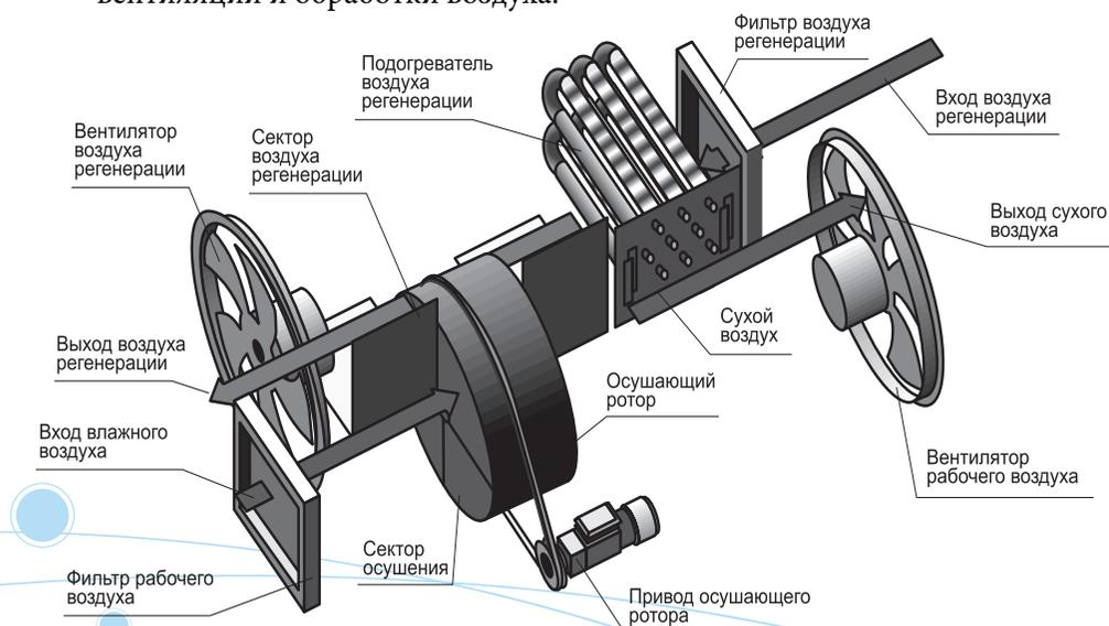
Принцип работы заключается в использовании влагопоглощающего ротора, располагающего высокими адсорбирующими свойствами.
