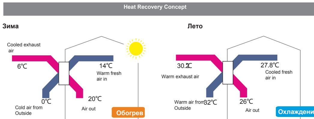
зима: приточный воздух в помещение  $t = (t \text{ в помещении} - t \text{ снаружи}) * \text{эффективность обмена} (\%) + t \text{ снаружи}$ .
