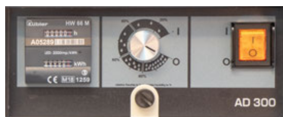
Встроенный счетчик часов наработки и электроэнергии показывает совокупное время наработки и затраченную электроэнергию
