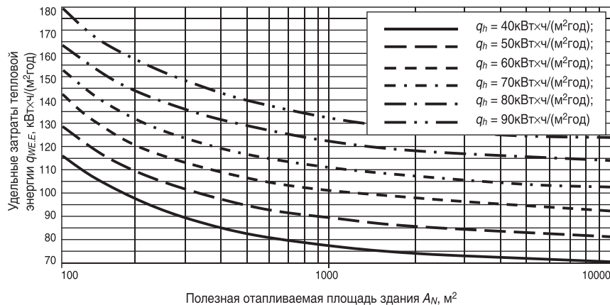
Рис. 16. Зависимость тепловых затрат здания от теплопотери и отапливаемой площади
