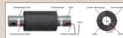
Монтаж кабеля на трубу
