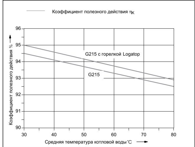
Диаграмма: Нормативный коэффициент полезного действия в зависимости от средней температуры котловой воды
