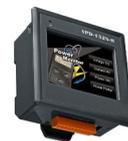
За дополнительную плату возможно применение панели VPD-173N <https://ipc2u.ru/catalog/vpd-173n> (поставка под заказ 4 недели) в качестве второго пульта, с которого можно управлять только пользовательскими функциями (сервисные настройки – с основного штатного пульта, располагаемого за пределами помещения бассейна, например, в венткамере).
