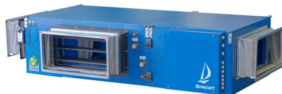
Вентустановка поддерживает постоянную циркуляцию воздуха внутри бассейна и предотвращает образование конденсата. Приточная и вытяжная часть установки могут быть совмещенными (напольное исполнение), или отдельными, в виде отдельных модулей (напольное и подпотолочное исполнение)
