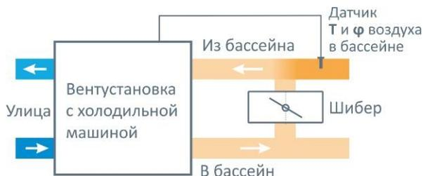
Если воздухопроводная сеть имеет невысокое сопротивление, то фактический расход воздуха может быть выше оптимального значения. В этом случае на этапе пуско-наладки необходимо уменьшить управляющее напряжение на вентиляторе в Рабочем режиме, чтобы фактический расход воздуха был равен оптимальному расходу, указанному в характеристиках. Для Дежурного режима необходимо установить меньшее напряжение (ориентировочно 50% от напряжения для Рабочего режима).
