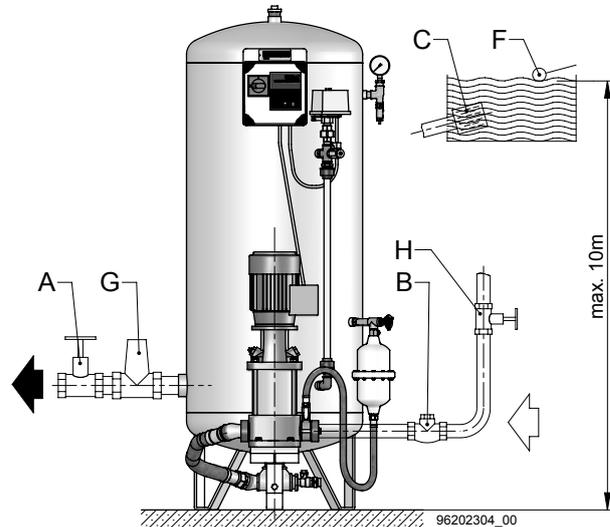
Die Pumpe wird an ein Wasserreservoir angeschlossen.
