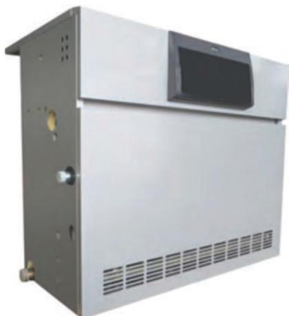
Напольный чугунный газовый одноконтурный котёл MAXIMA с двухступенчатой атмосферной горелкой пред-назначен для отопления помещений различного назначения. Выпускается одиннадцать типоразмеров номинальной теплопроизводительностью от 90 до 279 кВт.
