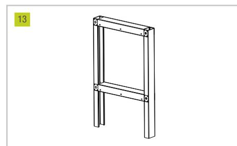
(\*) При использовании коаксиальных дымоходов Ø 60/100 мм или Ø 80/125 мм с выходом дыма из задней боковой стенки котла через отвод 90 градусов необходимо приобрести комплект задней проставочной рамы, код 20120468 (глубина 75,5 мм).
