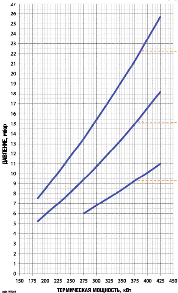
Потери напора (головка сгорания + газовая рампа + регулятор давления) BGN 40DSPGN ME ПРИРОДНЫЙ ГАЗ CE / EXP
