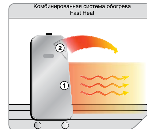
Тепло быстрее на 25% за счет комбинации инфракрасного и конвективного обогрева
