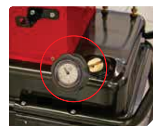
Датчик уровня топлива
