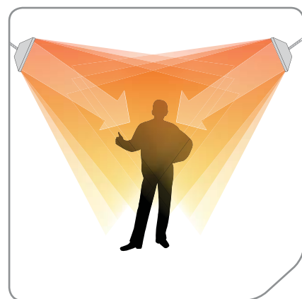
Возможна установка под углом, позволяющая повысить эффективность обогрева
