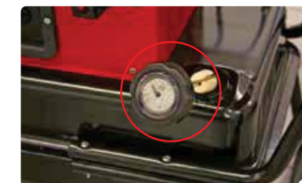
Датчик уровня топлива
