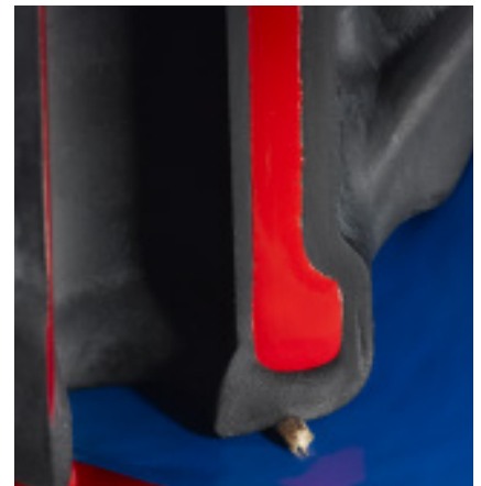
В закрытом положении примеси поглощаются резиной
