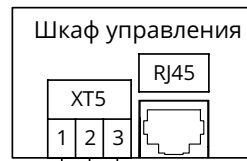
Выходы на внешнее устройство сигнализации или сбора информации по протоколу Modbus
