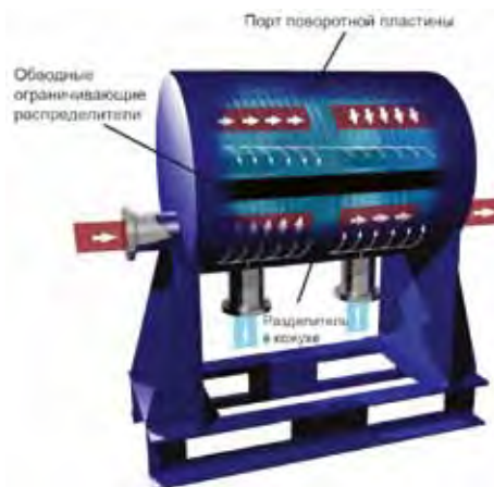
Схема течения теплоносителей в многоходовом теплообменнике AlfaDisc.
