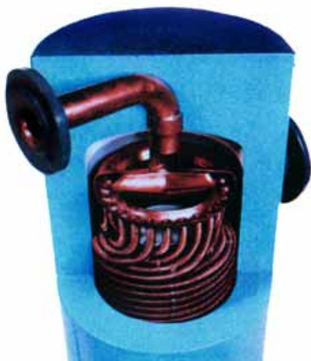
Размещение трубного пучка внутри кожуха
