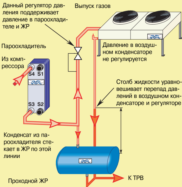
Рис. 11А. Отвод конденсата из пароохладителя
