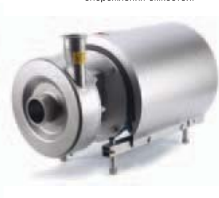
LKHSP Самовсасывающий насос для пищевой, фармацевтической и других отраслей промышленности. Может использоваться для систем безразборной мойки (CIP) с возвратом моющей жидкости и для опорожнения емкостей.
