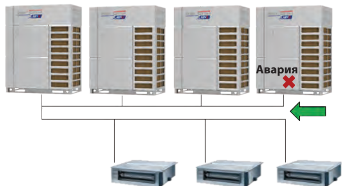
Извлечение хладагента из наружного блока
