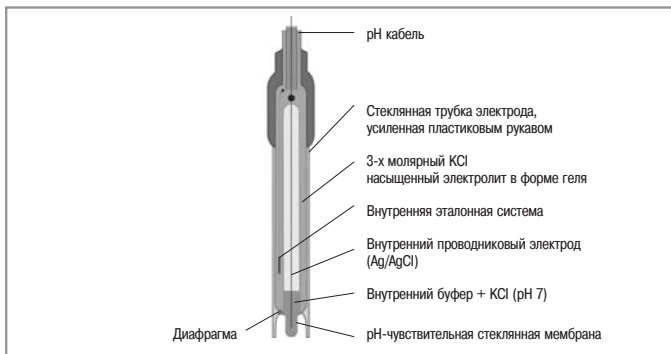
Рис. 10: Конструкция комбинированного электро́да с гелевым электролитом
