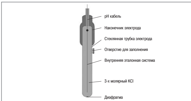
Рис. 8: Конструкция электрода сравнения
