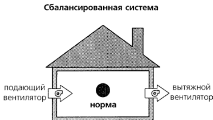
Рис. 8.3. Принудительная вентиляция и давление воздуха внутри дома.
