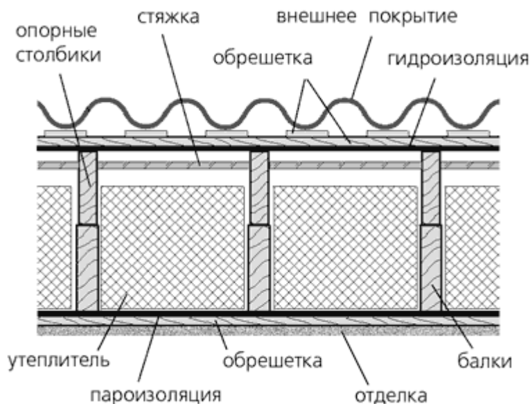
Рис. 5.15. Конструкция утепленной крыши.
