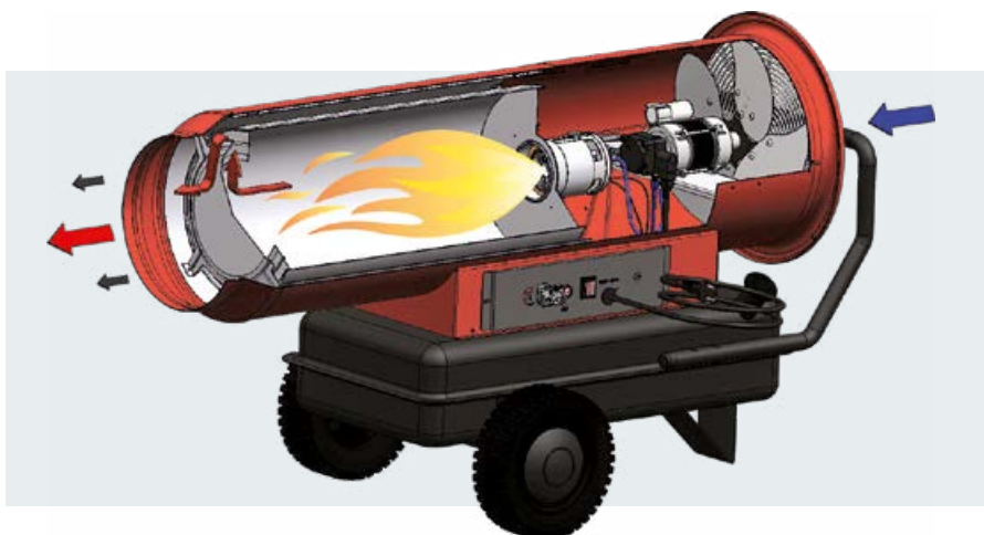
❖ Фото 2. Принципиальная схема устройства тепловой пушки прямого нагрева
