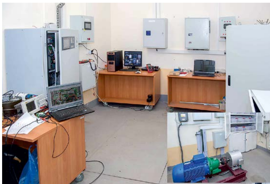
❖ Фото 2. Экспериментальный стенд для исследования режимов работы энергокомплекса на основе использования ВИЭ с интеллектуальной системой управления
