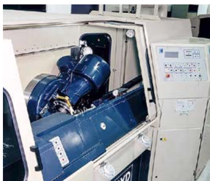
•• Фрезерование ротора винтового компрессора Hanbell на высокоточном фрезервальном станке
