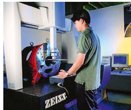
❖ Контроль параметров геометрии ротора винтового компрессора Hanbell
