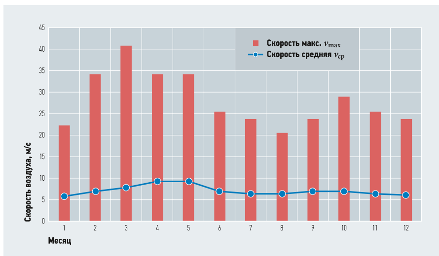
Рис. 2. Зависимость скорости ветра на высоте 100 м от календарного месяца в Забайкальском районе
