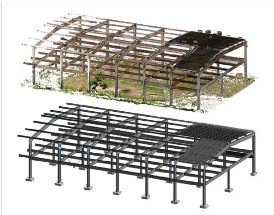
●● Рис. 2. Оцифровка существующих проектов (цифровой двойник) по облаку точек
