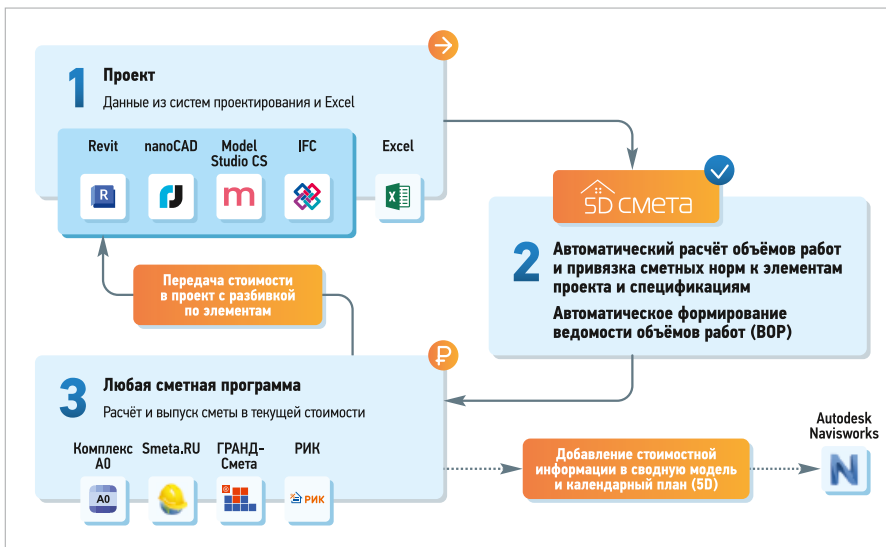
•• Рис. 5. Схема работы «5D Смета» — ПО для интеграции сметной информации в BIM-проекты
