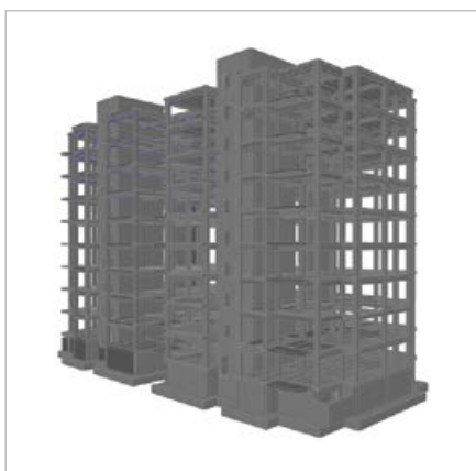
● ● Фото 9. Сводная модель по разделу КЖ в CADLib «Модель и Архив»
