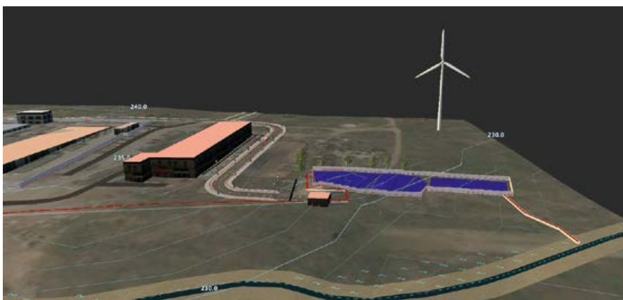
Рис. 3. Модель привязки здания в Autodesk InfraWorks 360
